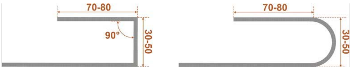
Rysunek 4 Schemat i parametry [cm] zakończenia wygradzenia dla płazów i gadów w kształcie litery U[15]
